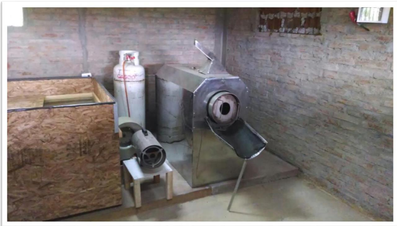
Secador de turbina y horno rotatorio
